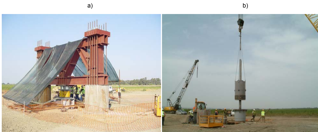
Figura 21 – Ensaio de carga realizados: a) ensaio estático vertical, b) ensaio dinâmico à compressão
