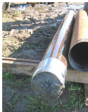
Figura 12 – Pormenor do amostrador Geobor S
