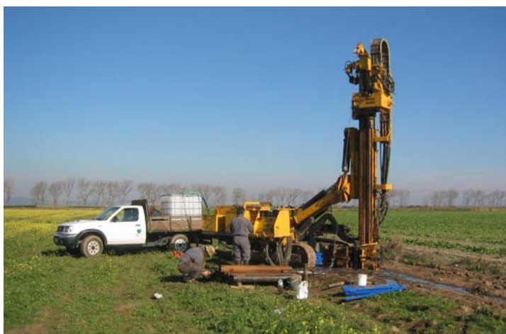
Figura 11 – Equipamento de sondagem equipado com amostrador triplo Geobor S
