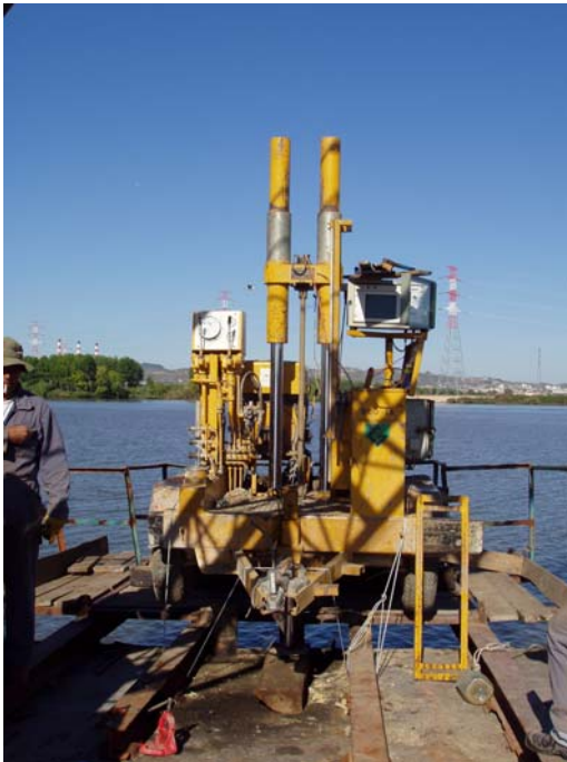
Figura 13 - Vista geral do equipamento utilizado no ensaio com penetrómetro estático com piezocone (CPTU)
