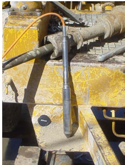
Figura 14 - Pormenor da ponteira do CPTU
